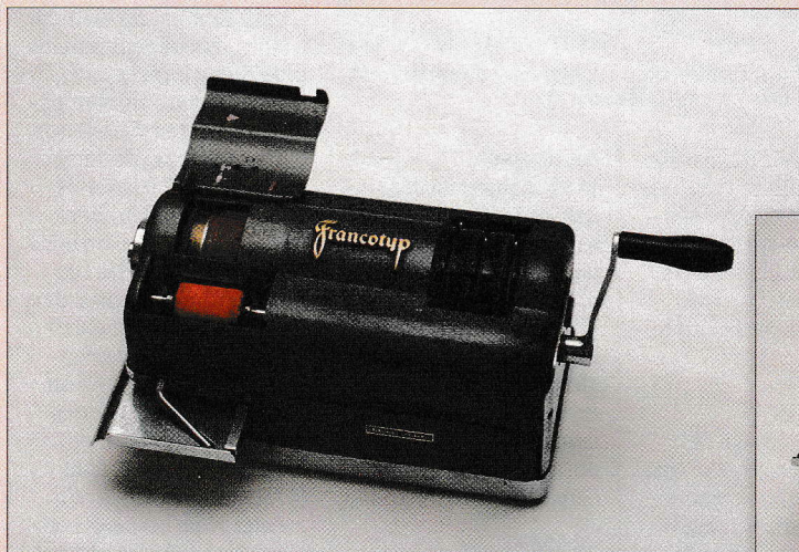
Links: afbeelding 1 - Handfrankeermachine Francotyp FR 7438 van de firma Ruys. Door het geopende klepje is het roletje met rode inkt te zien (foto: Roel Custers, Sittard).
